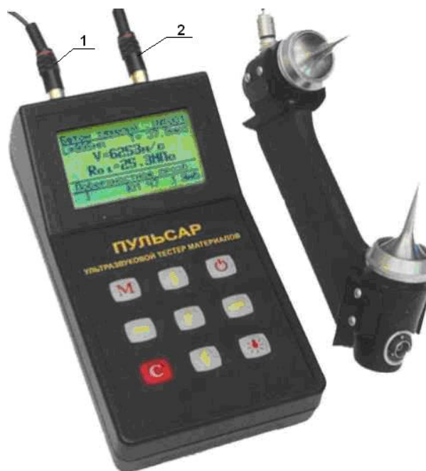
Рисунок 8 — Прибор "Пульсар - 1.0": 1 – вход подключения приемного преобразователя; 2 – выход подключения излучающего преобразователя.
