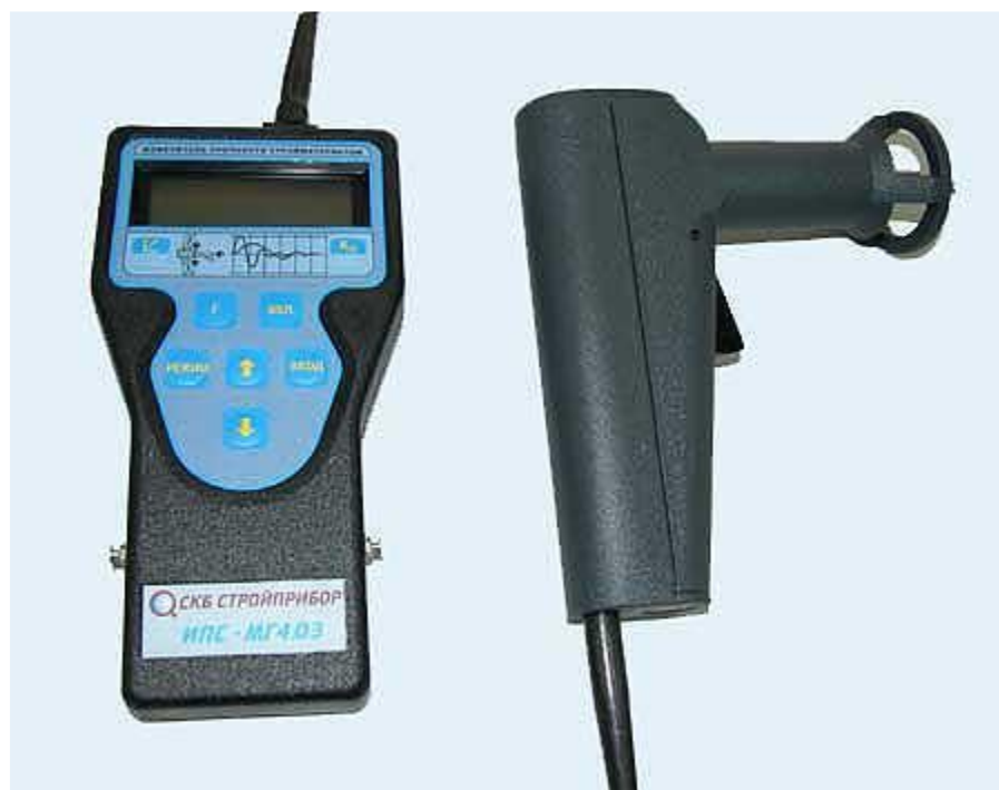
Рисунок 1 – Электронный измеритель прочности бетона ИПС-МГ4
